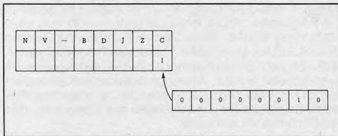
Bild 11. Das Carry-Bit als Bit 8 einer Rechenoperation
